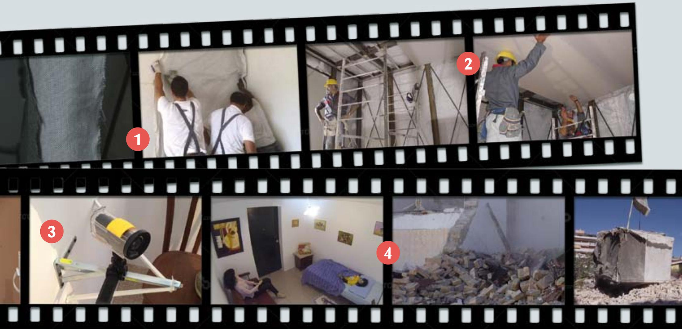
Alcune videocamere sistemate all'interno della cellula antisismica documentano un crash-test effettuato a Pescara città. Un prototipo della Madis Room viene montato in una vecchia palazzina da demolire, al suo interno è stata allestita una stanza con arredi e manichini per avvicinarsi il più possibile ad una situazione di vita reale.
